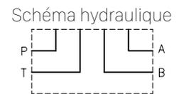
Bloc acier avec orifices A-B latéraux, P-T latéraux et arrières 3/8"BSP avec limiteur de pression. Poids = 3 Kg
