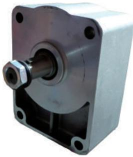
Les contre-paliers tendeurs de courroie avec arbre conique ou cylindrique série 25400 et 25600, sont employés pour les transmissions indépendantes de pompes hydrauliques par courroie ou par chaîne où sont présentes des grandes charges radiales. Ils sont directement bridés à la pompe et l'accouplement se fait par un demi accouplement cannelé. La durée des contre-paliers est de 3500 heures à 1500 tr/min.
