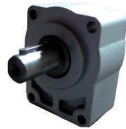
Les contre-paliers tendeurs de courroie avec arbre de commande conique ou cylindrique série 25400 et 25600, sont employés pour les transmissions indépendantes de pompes hydrauliques par courroie ou par chaîne où sont présentes des grandes charges radiales. Ils sont directement bridés à la pompe et l'accouplement se fait par un demi accouplement cannelé. La durée des contre-paliers est de 3500 heures à 1500 tr/min.
