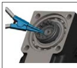
6.3 - Repositionner à l'aide de la pince prévue le circlip dans le siège du pivot en vérifiant de l'avoir parfaitement introduit. **Attention : NE PAS ELARGIR OUTRE MESURE LE CIRCLIP POUR NE PAS LE DÉFORMER DE MANIÈRE PERMANENTE.**
