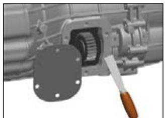
**4.3** - Vérifier que l'engrenage de la boîte de vitesses est compatible avec l'engrenage de la prise de force comme position, inclinaison de la dent et taille des dents. Ceci sert comme vérification supplémentaire sur le choix correct de la prise de force pour la boîte de vitesses spécifiée.
