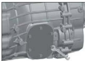
**4.1** - Dévisser le bouchon de vidange et éliminer l'huile de la boîte de vitesses. Revisser le bouchon de vidange avec le couple de serrage indiqué sur le manuel de la boîte de vitesses.
