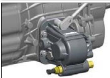
**4.9** - Après avoir établi le jeu optimal, serrer définitivement les écrous et les vis de la PTO avec un couple de serrage comme dans le TABLEAU 3 Chap.3.
