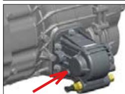
**4.7** - Monter la prise de force et serrer les écrous avec un couple inférieur au couple définitif.
