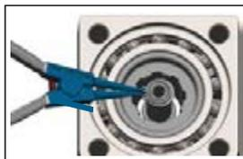
6.1 - Retirer à l'aide de la pince prévue le circlip de son siège sur le pivot central. **Attention : NE PAS ELARGIR OUTRE MESURE LE CIRCLIP POUR NE PAS LE DÉFORMER DE MANIÈRE PERMANENTE.**
