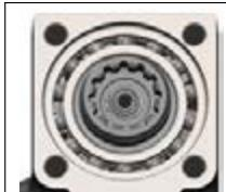
ATTENTION : un mauvais positionnement du circlip ou sa déformation pendant le montage pourrait causer le non-désamorçage de la prise de force.
