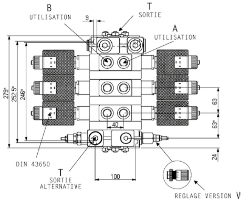
\* Ces dimensions diminuent de 21 mm sans l'option valve de flux réglable
